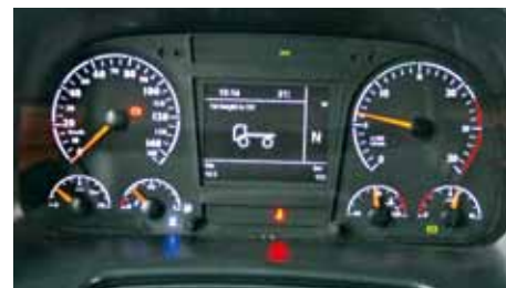
↑ Щиток приборов удобен и лаконичен: шесть стрелочных указателей и монохромный дисплей
