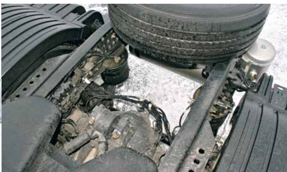
Баки Фотона вмещают 840 л солярки и 65 л мочевины
