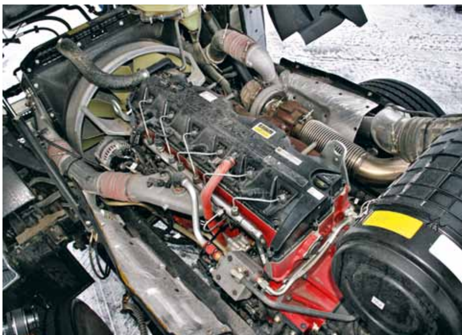
↑ Под кабиной – дизель Cummins ISG12 в вариантах мощности 419, 450 или 473 л.с.
