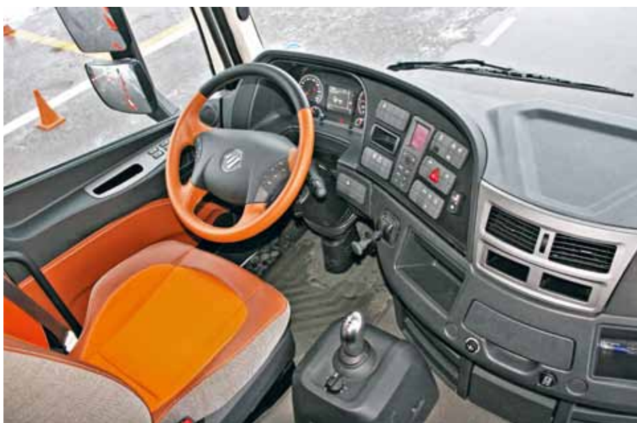
↑ Интерьер кабины выполнен по лекалам Mercedes-Benz Actros прошлого поколения. Но вот вместо удобного мерседесовского селектора в подлокотнике водительского кресла китайцы разместили селектор автоматизированной коробки ZF на «тумбочке» справа от сиденья, напрочь перегородив проход к «спальнику»
